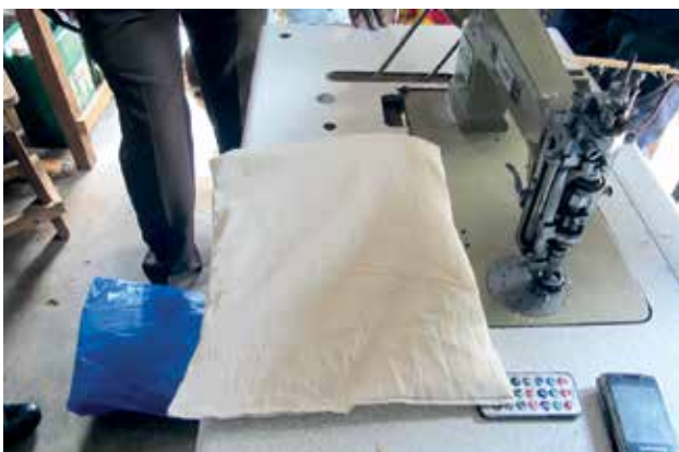
Die mit Silikagel gefüllten Baumwollbeutel wurden von Hand gefertigt und in die Truhen gelegt.
