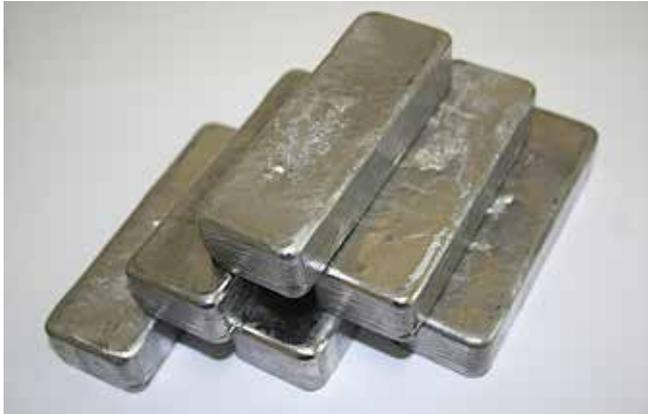
Fig. 2.4.1.2-1: Bleibarren | Lead ingots
