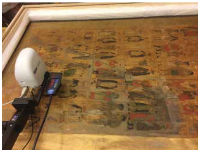
Fig. 1.2.7-2: Ramanspektroskopische Untersuchung der japanischen Karte Bankoku sōzu Jinbutsuzu im MARKK (siehe Karte 4.8, S. 323). | Examination of the Japanese map Bankoku sōzu Jinbutsuzu in the MARKK using Raman spectroscopy (see map 4.8, p. 323).
