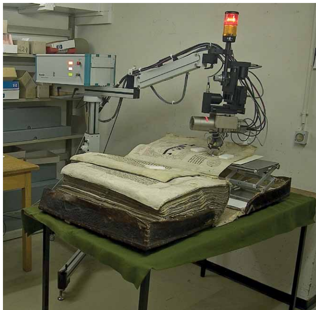
Fig. 1: Tintenuntersuchungen an der hebräischen Riesen-Bibel „Erfurt 1“, Ms. or. fol. 1210/1211, Staatsbibliothek zu Berlin (Hahn et al. 2008), mittels Mikro-Röntgenfluoreszenzanalyse, RFA (ARTAX, Bruker Nano GmbH). | Ink analysis of the Giant Hebrew Bible, 'Erfurt 1', Staatsbibliothek zu Berlin (Hahn et al. 2008), using the micro-X-ray fluorescence technique, XRF (ARTAX, Bruker Nano GmbH).
