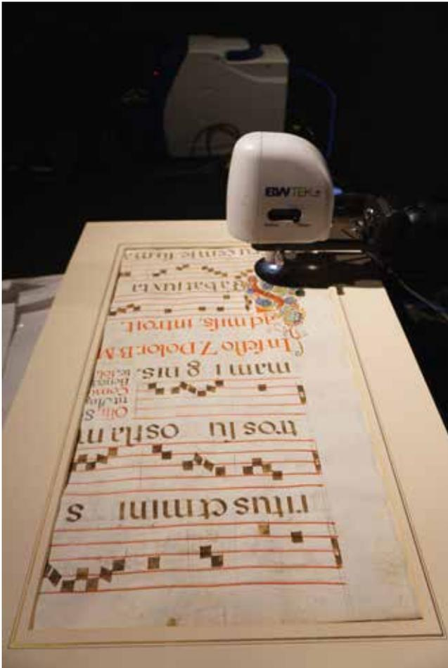
Fig. 2.2-4: Ramanspektrometer B&W Tek i-Raman plus. | Ramanspektrometer B&W Tek i-Raman plus.
