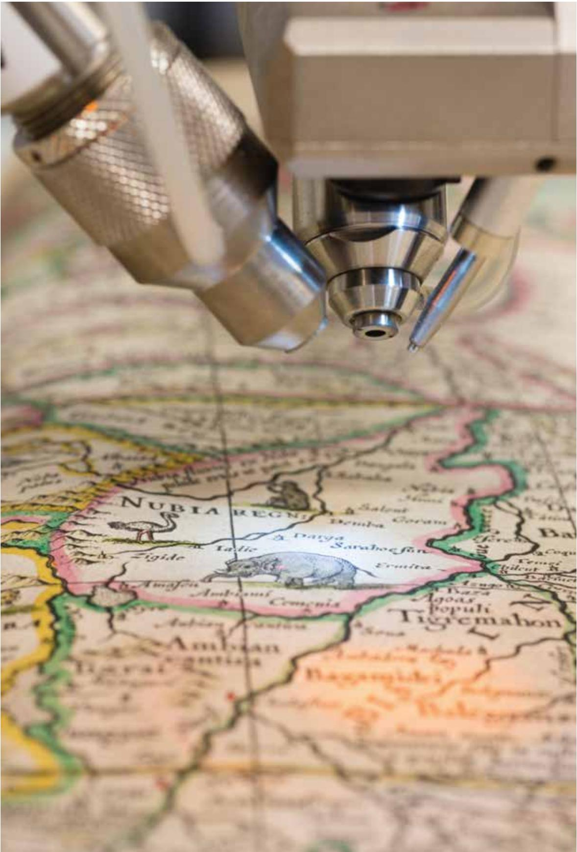
Fig. 2.1-1: Messkopf des mobilen Bruker Röntgenfluoreszenz-Spektrometers ARTAX über einer Karte des *Le Grand Atlas*, Joan Blaeu, 1667. | Measuring head of the portable Bruker X-ray fluorescence spectrometer ARTAX over a map of *Le Grand Atlas*, Joan Blaeu, 1667.
